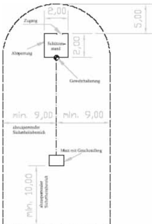
Abbildung 7.9.1 Sicherheitsbereich für Vogelschießstände
